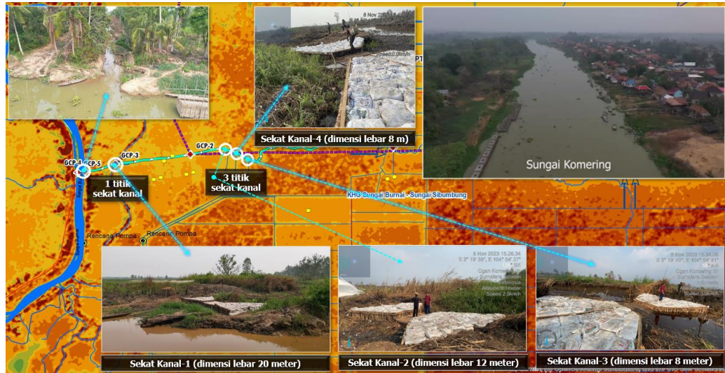
Gambar 88. Aksi Pembasahan (Rewetting System) Melalui Pembangunan Sekat Kanal di Lahan Masyarakat, Desa Tanjung Menang, Kecamatan Kayu Agung, Kabupaten Ogan Komering Ilir, Tahun 2023
