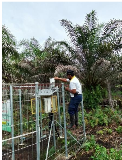
Instalasi Alat Pemantauan TMAT Gambut otomatis ( data logger )
