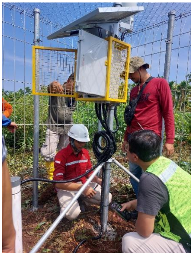
Instalasi Alat Pemantauan TMAT Gambut otomatis ( data logger )
