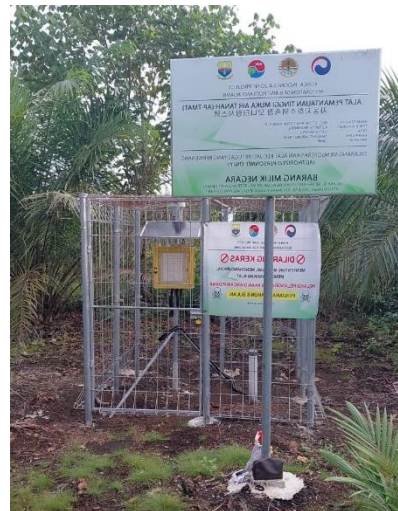
Instalasi Alat Pemantauan TMAT Gambut otomatis ( data logger )
