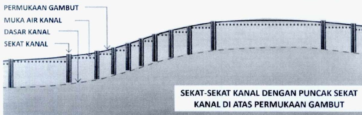
Gambar 1. Contoh sketsa penentuan letak sekat kanal di satu ruas kanal
