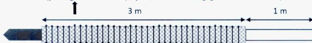
Gambar 26. Proses penyiapan pipa paralon
